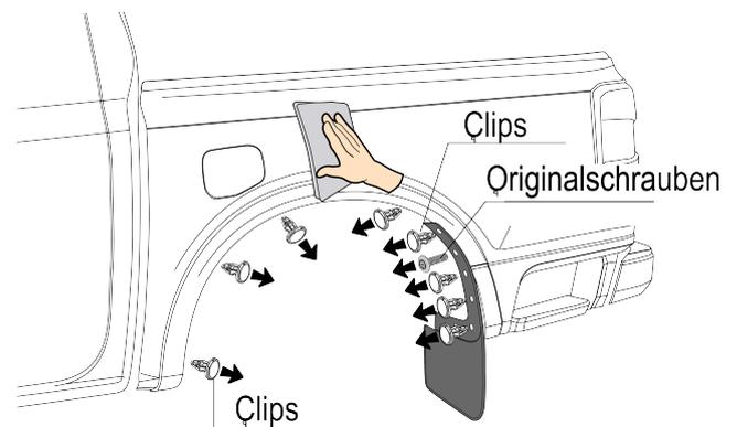
2. Drücken Sie nun die Kotflügelverkleidung vom Kotflügel und schieben Sie die Klemmen von innen über den Kotflügelrand, so dass die Bohrungen bündig sind. Achten Sie darauf, dass die Klemmen den Korrosionsschutz nicht beschädigen. Drücken Sie nun die Gewinde-Clips in die Löcher
